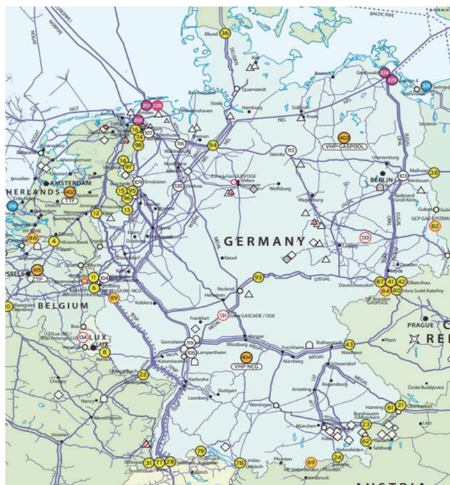
Σχήμα 16: Το Σύστημα Φυσικού Αερίου της Γερμανίας
