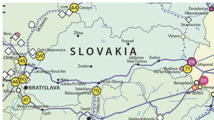
Σχήμα 18: Το Σύστημα Φυσικού Αερίου της Σλοβακίας
